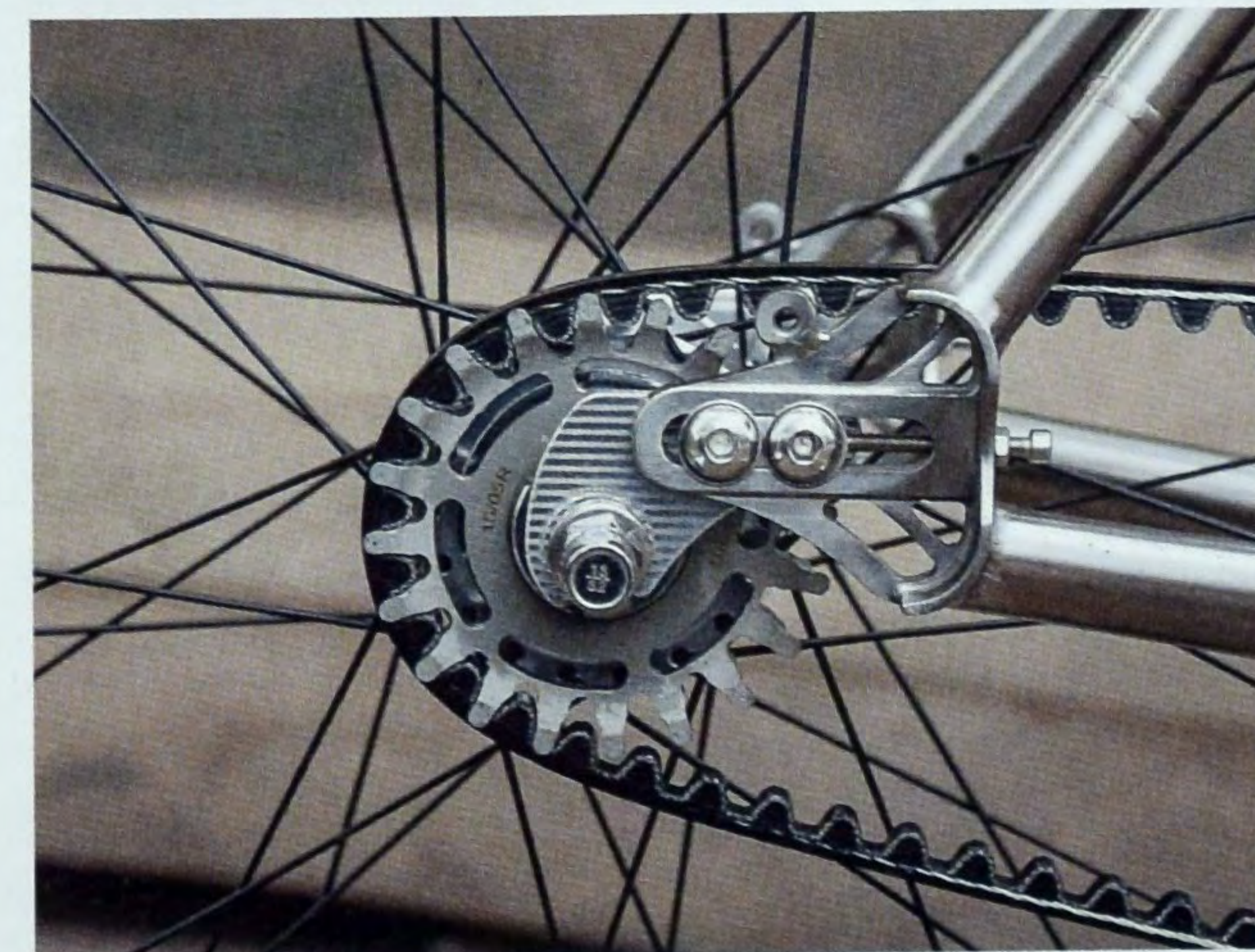
Der Riemenantrieb von Gates ist eine saubere und leise Sache. Beeindruckender ist die Formgebung des Hinterbaus am Fast Foot.
